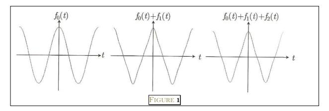
Ces représentations graphiques révèlent que la superposition des signaux  $f_0(t)$ ,  $f_1(t)$ ,... permet de générer une fonction f(t) périodique, de période  $T_0 = \frac{2\pi}{\omega}$ , définie par :
